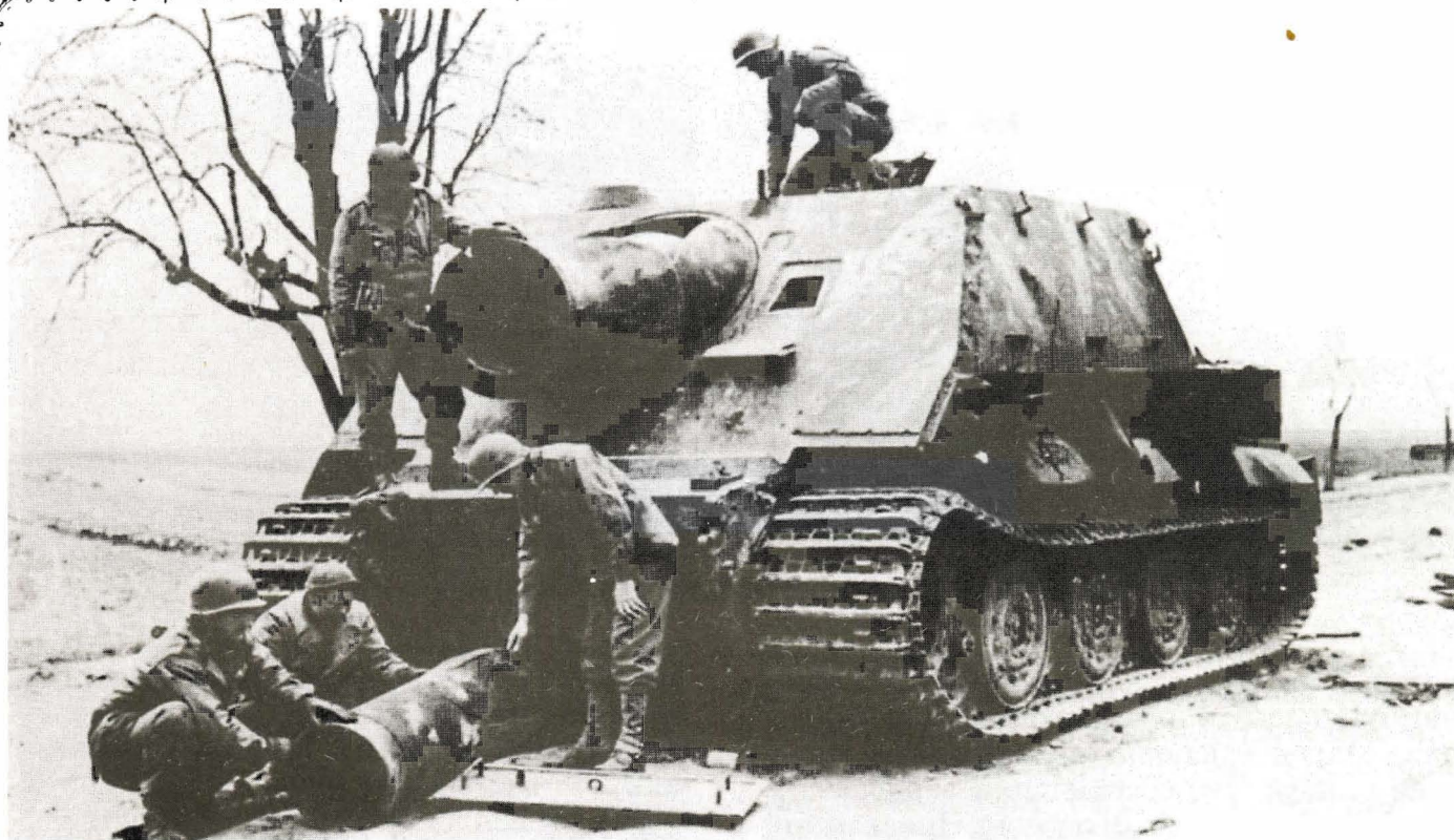
"Штурмтигр", захваченный американцами. Перед танком валяется внутренняя труба орудия, выброшенная взрывом
