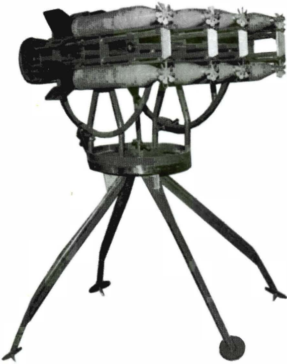
Горная пусковая установка на восемь 82-мм снарядов М-8
